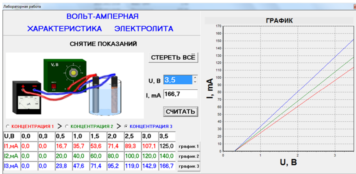
Рис. 8. График вольт-амперной характеристики электролита при различной концентрации раствора медного купороса
