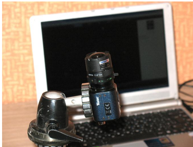
Рис.2.1. Камера Wat-902H с широкоугольным объективом T2314FICS. Поле зрения системы 129X99 град.
