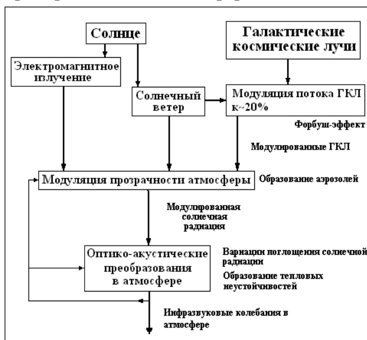
Рис. 2.3. Сценарий образования инфразвука в атмосфере под действием солнечного излучения, СКЛ и ГКЛ
